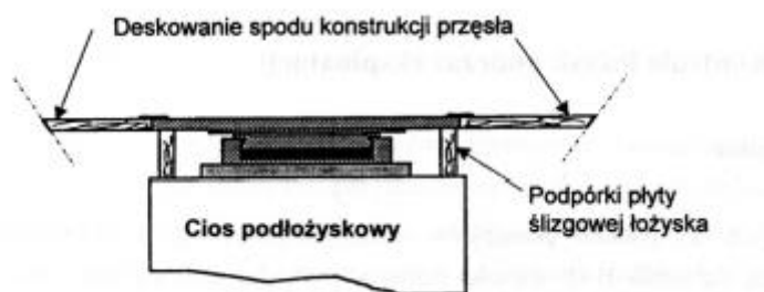
Rys. 7. Ustawianie łożyska w przypadku konstrukcji betonowanej na miejscu
